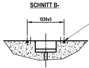
Bei Option „integriertes Wiegen“ bündig im Boden zu verankerndes Verankerungselement (122183):
